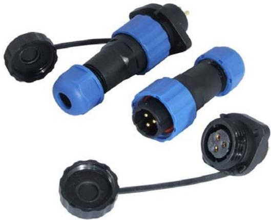
Герметичный разъём (комплект) с заглушкой SZC16 3P-M-FE, вилка-розетка, 3 контакта, диаметр входящего кабеля 8 мм, IP68, 10 А, 250 В, является пылезащищенным и влагозащищенным. Герметичный разъём соответствует высокой степени защиты, что гарантирует работу разъемов при длительном погружении в воду (более 30 минут) на глубину больше 1 м.
